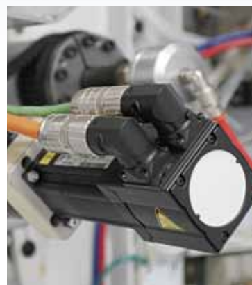
Movimento singole stazioni con motori brushless Brushless motor for movement of each single unit Mouvements de chaque groupe par moteurs "brushless" Movimientos de cada grupo con motores "brushless"
