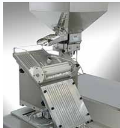
Alimentazione con vibratore orizzontale e spazzola rotante Feeding unit by means of horizontal vibrator and rotating brush Groupe d'alimentation avec vibreur horizontal et brosse tournante Alimentación mediante vibrador horizontal y cepillo giratorio
