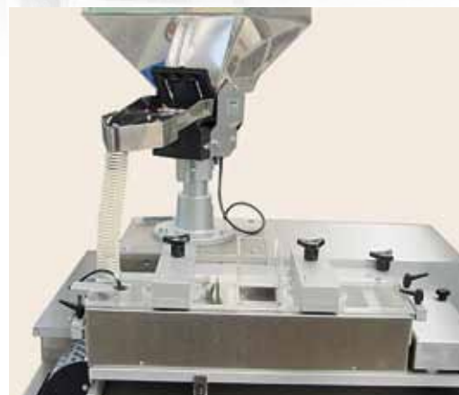
Alimentazione universale a spazzole rotanti Universal feeding system by means of rotating brushes Groupe d'alimentation universel par brosses tournantes Alimentador universal por medio de cepillos giratorios
