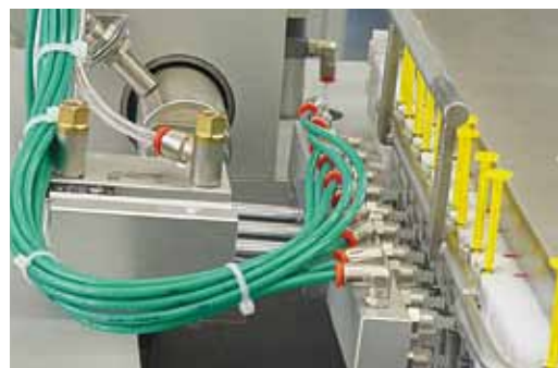
Sistema di alimentazione siringhe con "Pick & Place" Syringes feeding group by means of "Pick & Place" system Unité d'alimentation seringues par système "Pick & Place" Grupo alimentador jeringas mediante sistema "Pick & Place"
