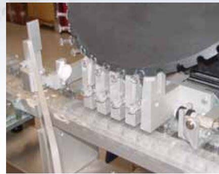
Sistema di alimentazione siringhe composto da vibratore orizzontale, ruota prelievo siringhe e dispositivo di caricamento cassonetti Syringes feeding group composed of horizontal vibrator, drawing wheel and tray charging device Unité d'alimentation seringues composé par vibreur horizontal, roue de prélèvement seringues et dispositif de chargement barquettes Sistema de alimentación jeringas compuesto por vibrador horizontal, rueda de toma jeringas y dispositivo de carga bandejas
