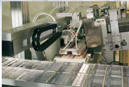
Sistema di alimentazione fiale con "Pick & Place" Ampoules feeding group by means of "Pick & Place" system Unité d'alimentation ampoules par système "Pick & Place" Alimentador ampollas mediante sistema "Pick & Place"
