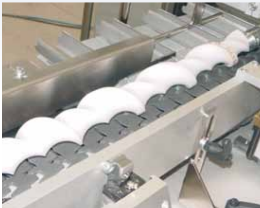
Gruppo di alimentazione ribaltamento flaconi Bottle feeding system complete with proper screw Unité d'alimentation flacons par vis sans fin Grupo de alimentación volcado frascos mediante tornillo sin fin
