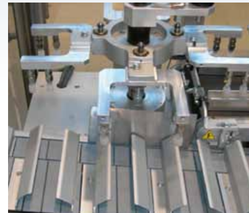
Gruppo alimentazione tubetti con sistema "Pick & Place" Tubes feeding system by means of "Pick & Place" device Unité d'alimentation tubes par système "Pick & Place" Grupo de alimentación tubos mediante sistema "Pick & Place"
